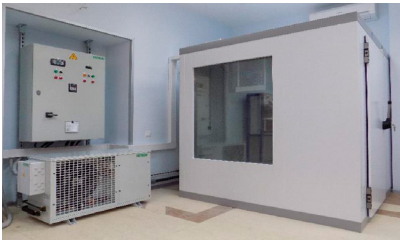
Рис. 2. Стенд «Холодильная камера с одноступенчатой холодильной установкой» от компании «Остров» для МГТУ им. Н. Э. Баумана
