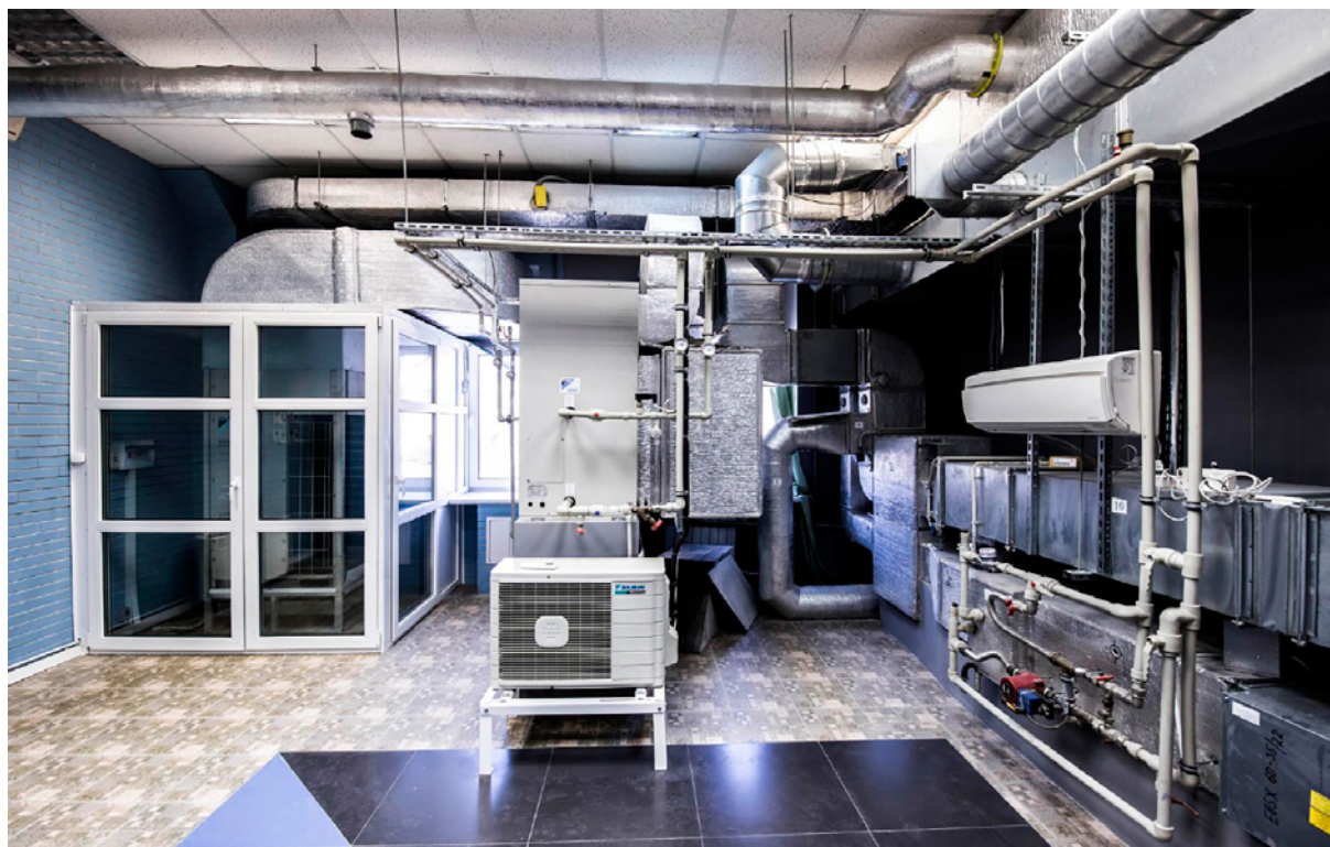
Рис. 1. Один из стендов университета ИТМО для изучения принципов работы холодильных систем и систем кондиционирования
