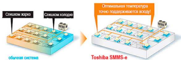
Рис. 6. В мультizonальных системах Toshiba SMMS-e реализована система равномерного охлаждения помещений, даже если некоторые из них находятся в более выгодном положении по сравнению с другими
